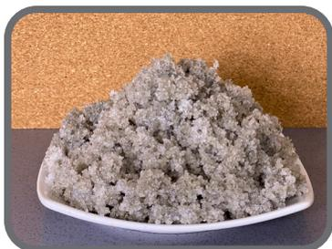
**BestDRY™ es una solución súper absorbente no peligrosa que se utiliza para convertir los desechos de lechada de concreto en un material seco que se puede disponer fácilmente sin implicaciones ambientales.**
